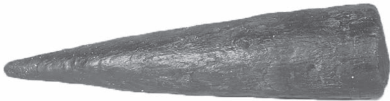
Fig. 6.13. Skothålsproppar består av koniska trästycken som användes för att täta skrovet efter fientlig beskjutning. De bankades helt enkelt in i kulhålen med spetsen först. Ett stort antal proppar i olika kalibrar har lyfts från Riksäpplet . Proppen på bilden är 57 centimeter lång och har en diameter på 13,6 centimeter. Sjöhistoriska museets inventarienummer 24460.
