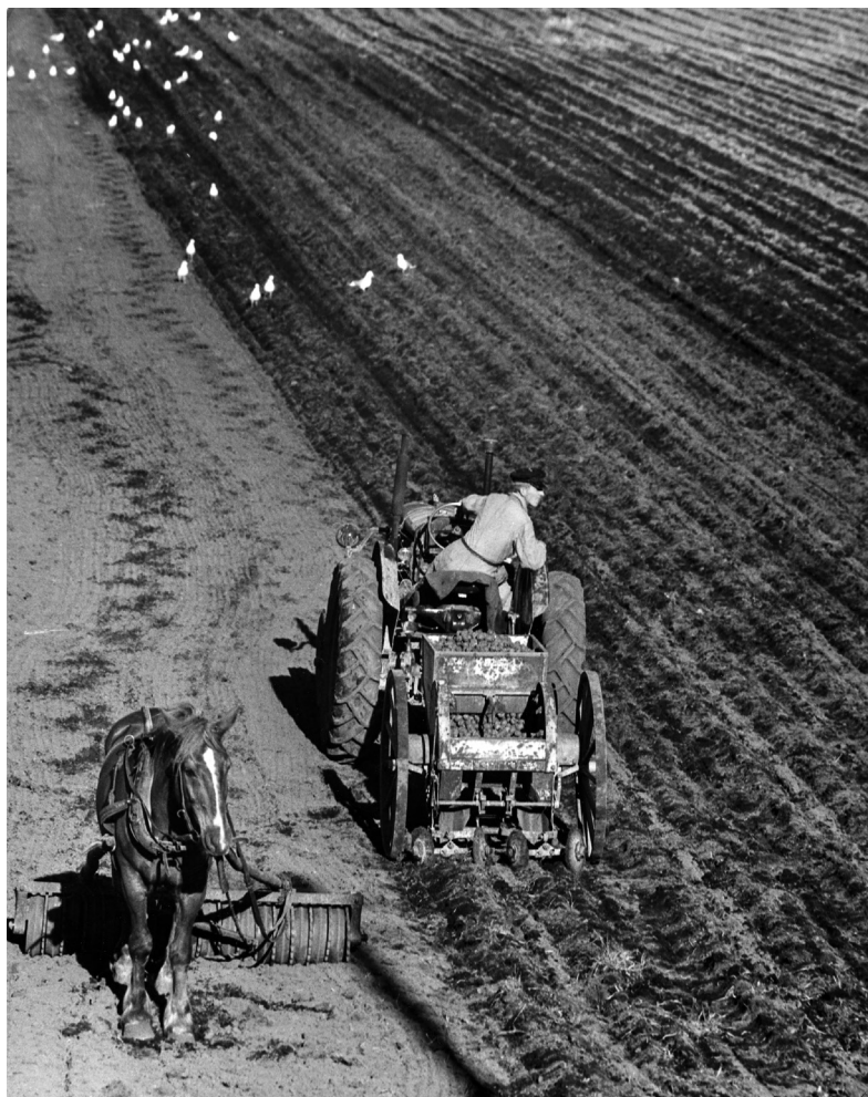
Traktorn ersatte under 1950-talet i allt större utsträckning hästen som dragkraft, och under en period kunde de användas parallellt. Traktorn drar potatissättaren, men ringvälten är ännu kopplad till häst. Blekinge, cirka 1950. Foto: Gunnar Lundh/Nordiska museet.
