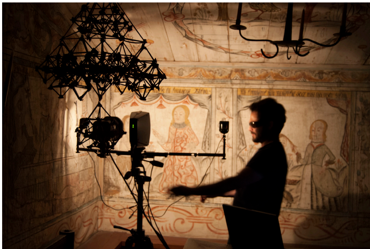
Figur 6 (3.1.6): Multispektralundersökning av väggmåleri. Foto: Ingalill Nyström
